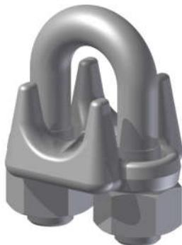
Die Seile werden einseitig mit gepressten Schlaufen geliefert. Es ist unbedingt zu beachten, dass die richtige Anzahl Drahtseilklemmen mit den vorgeschriebenen Drehmomenten verwendet werden. Falls die Drahtseilklemmen diebstahlsicher gemacht werden sollen, können sie geklebt werden (z.B. mit Loctite).
