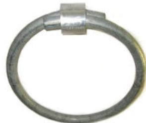
Die eingebauten Geobrugg Bremselemente (Bremsringe) haben die Aufgabe, durch plastische Verformung und Reibung Energie abzubauen, sowie auch das entsprechende Tragseil vor Überlast zu schützen. Das Stahlrohr schützt das Seil vor Korrosion und mechanischer Beschädigung.
