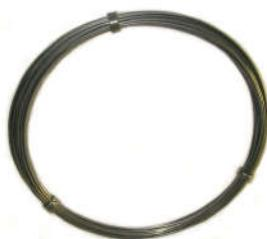
Das ROCCO-Ringnetz ist das Hauptelement des Systems und besteht aus hochfestem Stahldraht mit einer Festigkeit von mindestens 1770 N/mm<sup>2</sup> und einem Durchmesser von 3 mm.
