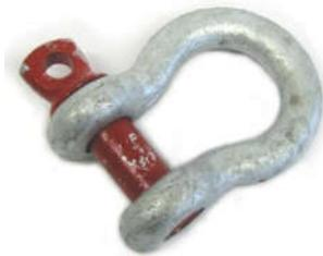
Die Verbindungen zwischen dem Ringnetz und den Seilen werden mit Schäkeln ausgeführt. Diese garantieren, dass das Netz auf dem Seil rutschen kann, ohne dass dieses beschädigt wird. Auch werden die Netze vertikal mit Schäkeln verbunden. Es gilt grundsätzlich, dass die Schäkel so ausgebildet sind, dass sie eine stärkere Verbindung darstellen als das Netz selbst. Um das Herausdrehen der Bolzen zu verhindern, können diese mit Draht befestigt oder verklebt werden.
