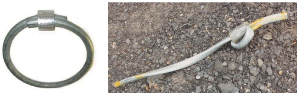
Abbildung 3.6: Bremsselement unbelastet (links) und gezogenes Bremsselement nach Belastung (rechts)
