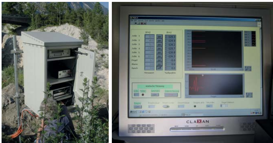
Abbildung 4.11: Datenerfassung mit Monitor, Notstrombatterie und Videorekorder (links) und Anzeige der Tragseilkräfte auf dem Monitor im Schaltschrank (rechts)
