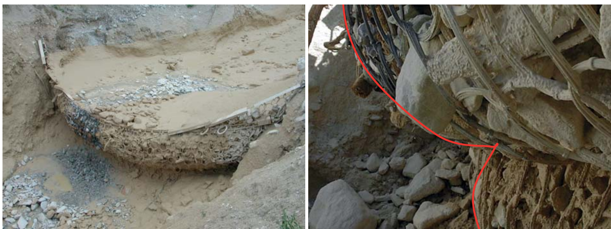
Abbildung 4.13: Gefüllte Barriere 2005: Übersicht (links) und Verformungsfigur als Doppelbauch (rechts)
