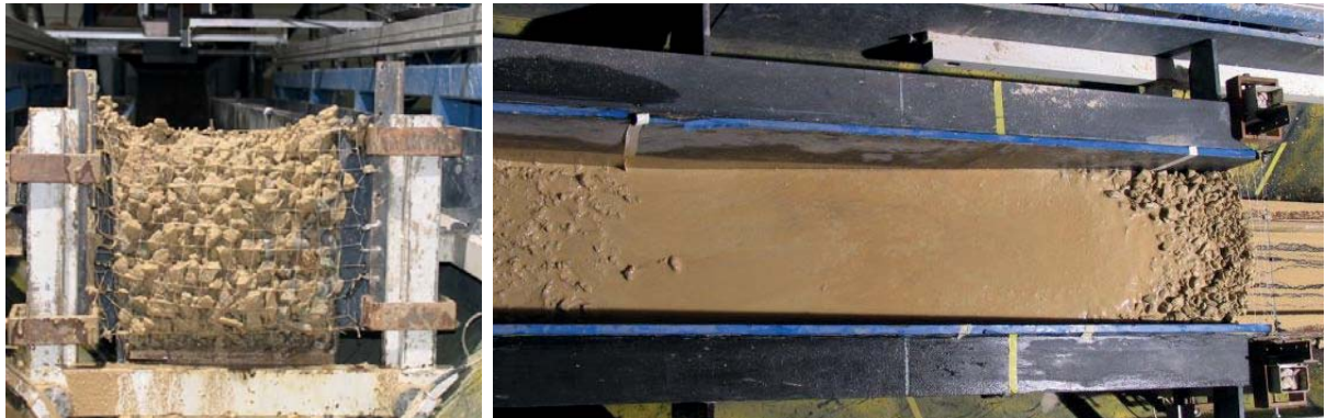
Abbildung 5.8: Durch den Murgang verfülltes Netz von vorne und von oben (Versuch mit Illgrabenmaterial bei 50 l Startvolumen und einer Neigung von 25%)
