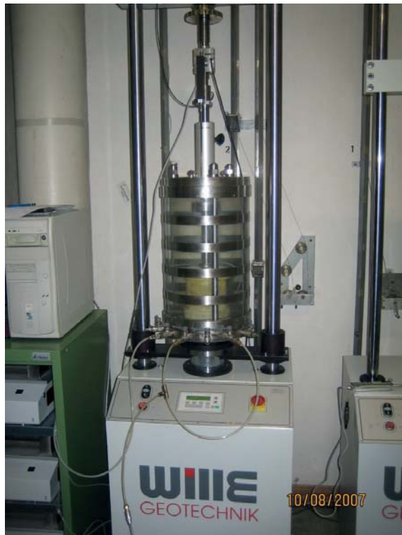
Abbildung 5.7: Triaxialgerät zur Bestimmung des inneren Reibungswinkels (links) und Funktionsweise des Triaxialgerätes erklärt durch die Mohr Coulombsche Bruchtheorie (rechts)
