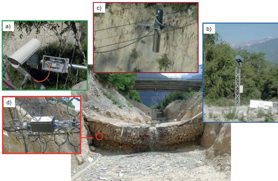
Abbildung 4.6: Forschungsbarriere mit Messtechnik: a) Videokamera, b) Scheinwerfer, c) Lasermessung und d) Kraftmesszellen in den Tragseilen.
