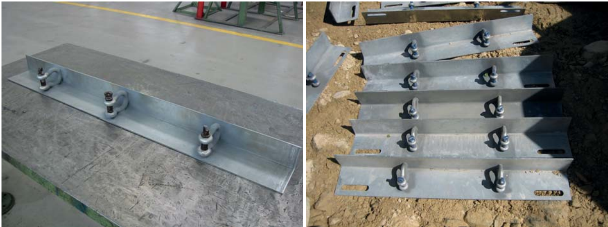
Abbildung 3.10: Abrasionsschutzblech 2005 ohne Langlöcher zur Verschäkelung (links) und Weiterentwicklung Abrasionsschutzblech 2006 und 2007 mit Langlöchern (rechts)
