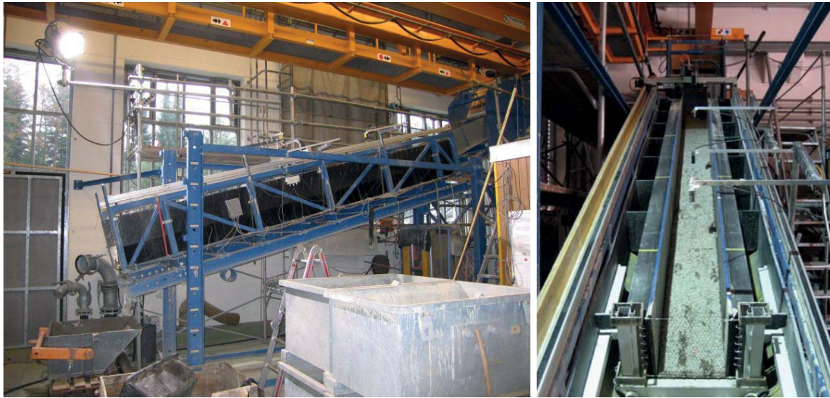
Abbildung 5.2: Murgangrutsche der WSL: Seitenansicht mit Auffangwanne und Materialbehälter im Vordergrund (links) und Draufsicht der Rinne mit Messlasern und eingebauter Barriere im Messschlitten (rechts)
