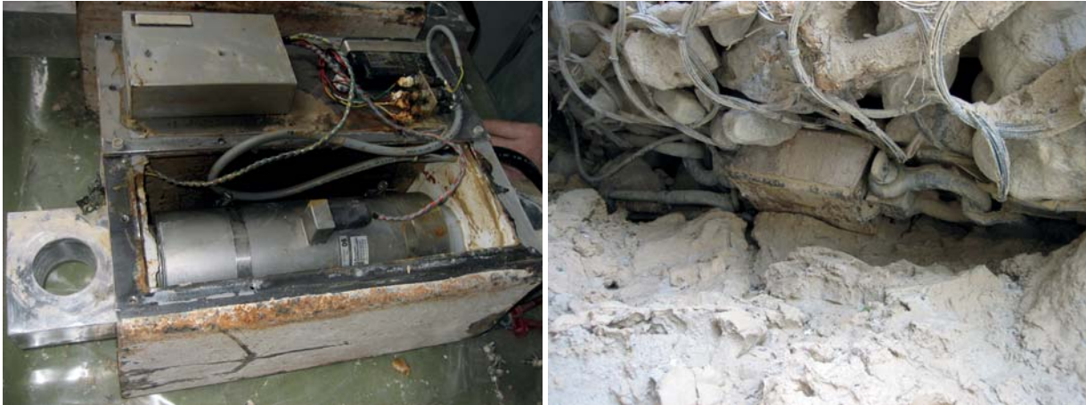
Abbildung 4.8: Geöffnetes Metallgehäuse mit eingebauter Messtechnik nach einer Murgangssaison (links) und Messzelle eingebaut im gefüllten Murgangnetz (rechts)
