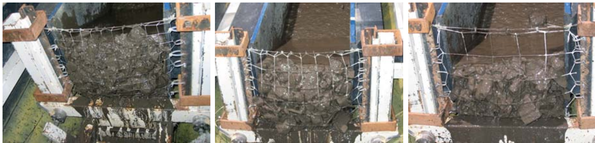
Abbildung 5.13: Einfluss der Maschenweite auf den Materialrückhalt mit Haslibergmaterial [109]: Links 3 cm, Mitte 4 cm und rechts 6 cm
