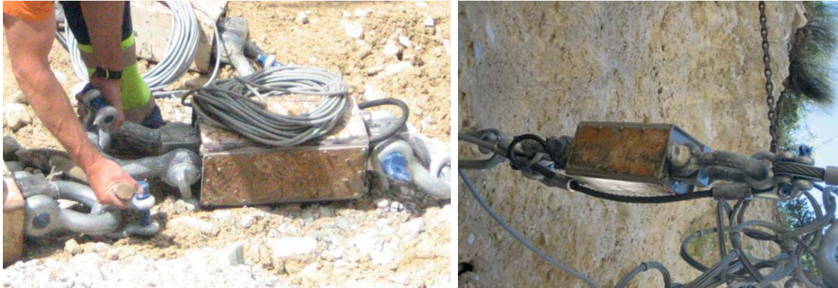
Abbildung 4.10: Messzelle mit Daten- und Stromkabel beim Einschäkeln (links) und fertig eingebaut im gespannten Tragseil (rechts)
