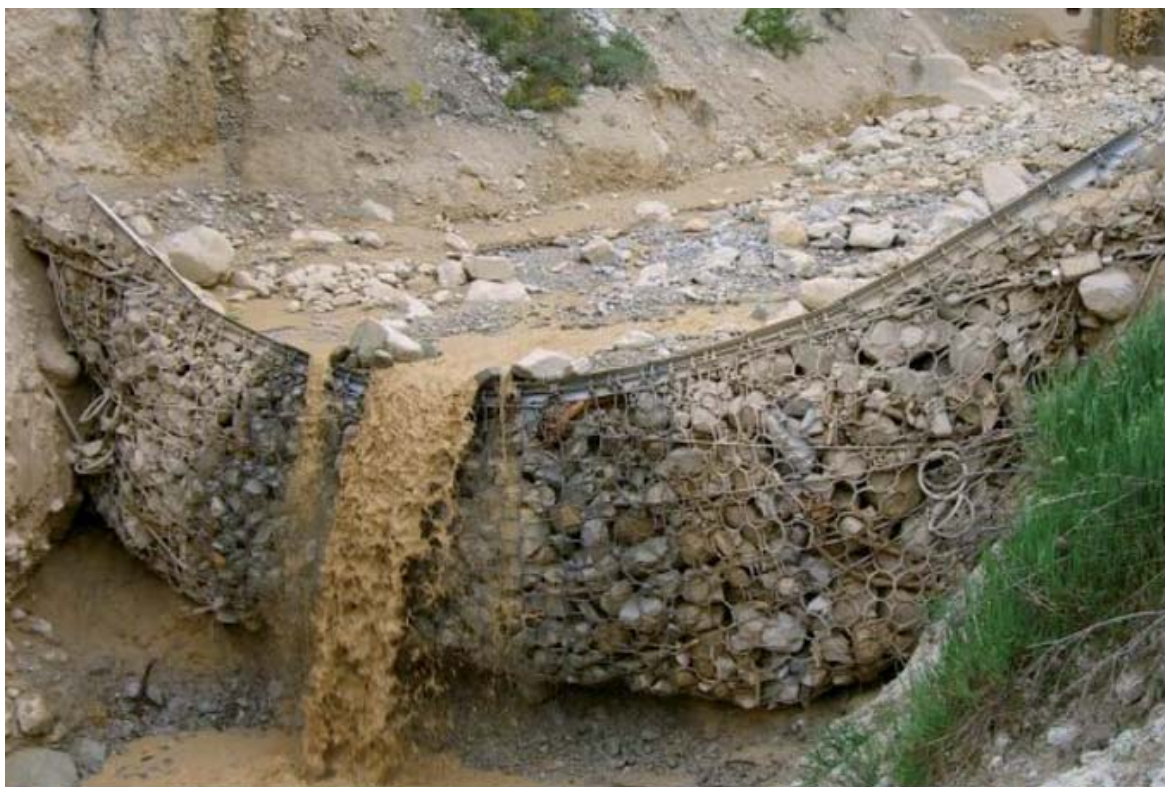
Figur 15. Her har et fleksibelt ringnett – gjerde blitt testet ut av et naturlig flomskred i Illgraben. Skredet var så stort at det strømmet over gjerdet (overtopping). Gjerdet fanget opp ca.1000 kubikk (Foto: Geobrugg)
