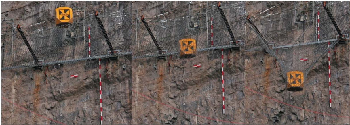
Figur 8. Fullskala testforsøk av RXE fanggjerdet i Walenstadt, Sveits (Foto: Geobrugg)
