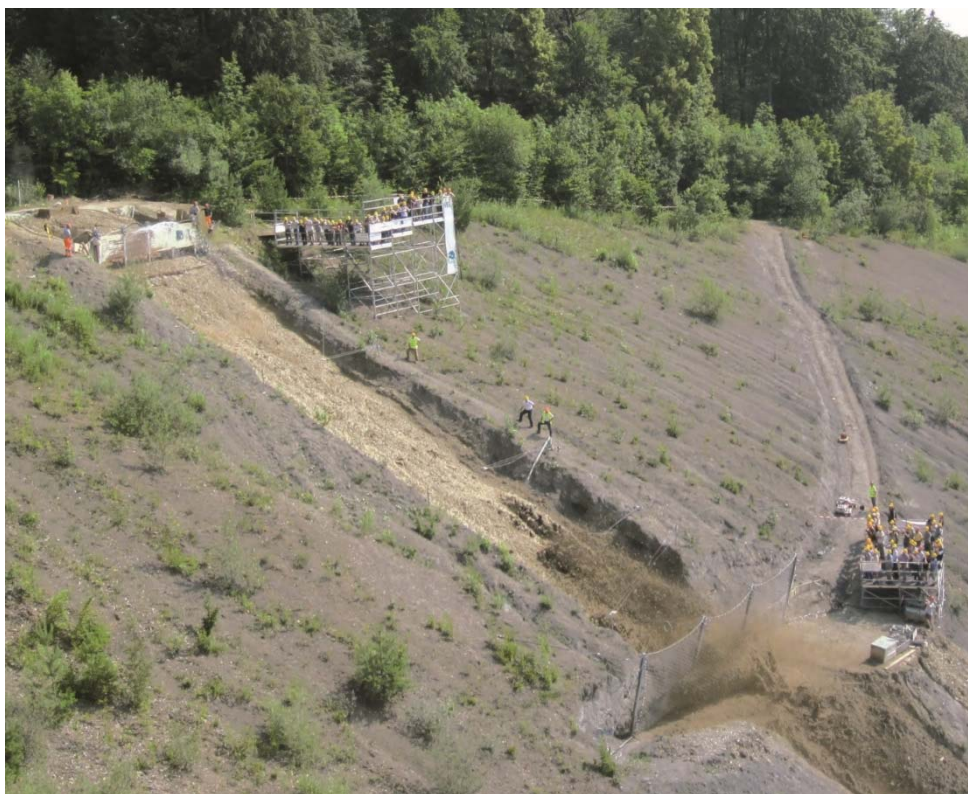
Figur 22. Fullskala testforsøk av fanggjerdet for jordskred (Foto: Geobrugg)
